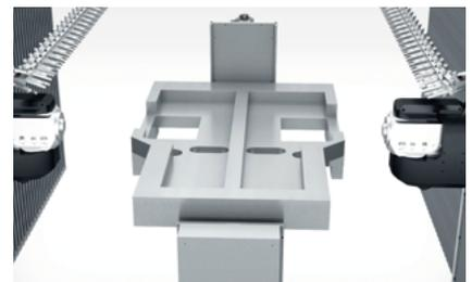
*Die A-Achse ermöglicht die freie Positionierung des Werkstücks.*
