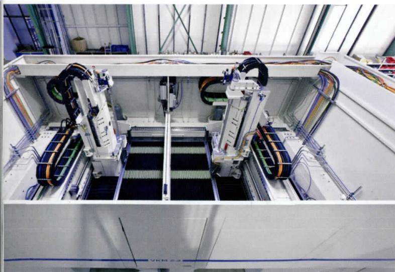
Durch den modularen Aufbau ist vom 1-Kammer-Prinzip bis hin zum zweispindligen 2-Kammer-Parallelbetrieb alles möglich
